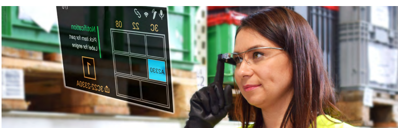
Imagen 1: Los trabajadores de primera línea reciben instrucciones paso a paso sobre el flujo de trabajo a través de sus gafas inteligentes.
