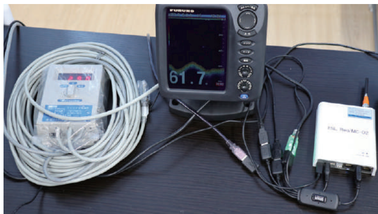
魚群探知機と温度計を接続したデータ収集端末(右端)
